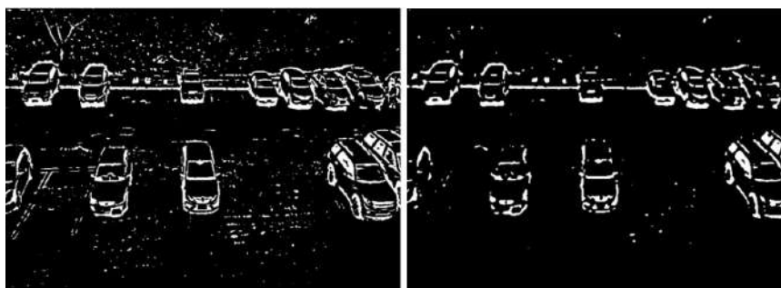
Figura 7. Eliminación de ruido aplicando filtro de mediana
