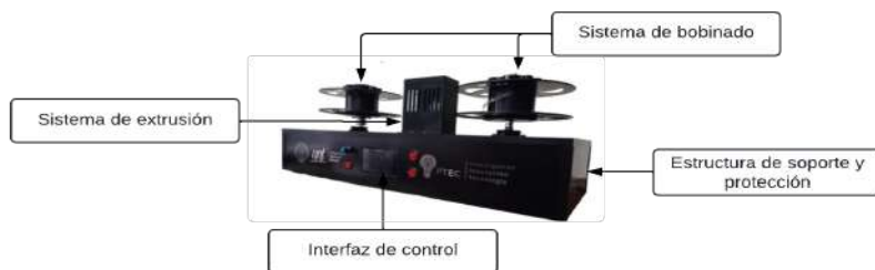
Figura 8. Extrusora de filamento para impresión 3D a partir de material reciclado PET con sistema IoT
