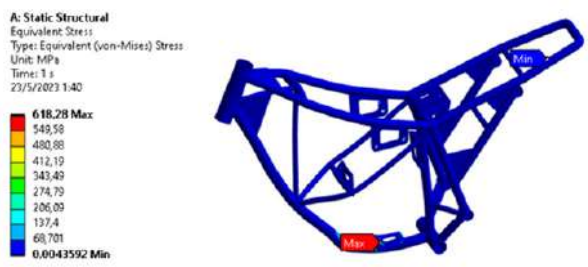
Figura 13. Esfuerzos maximos identificados en la curvature del perfil estructural
