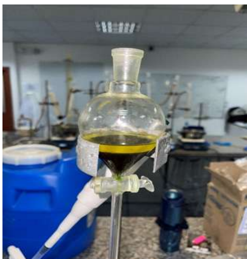
Figura 6. Separación de fases en embudo de decantación.
