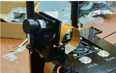
Figure 4: Cámara ArduCam mini 12.3 IMX477
