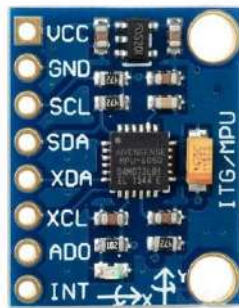
Figura 2. Sensor MPU6050 - acelerómetro
