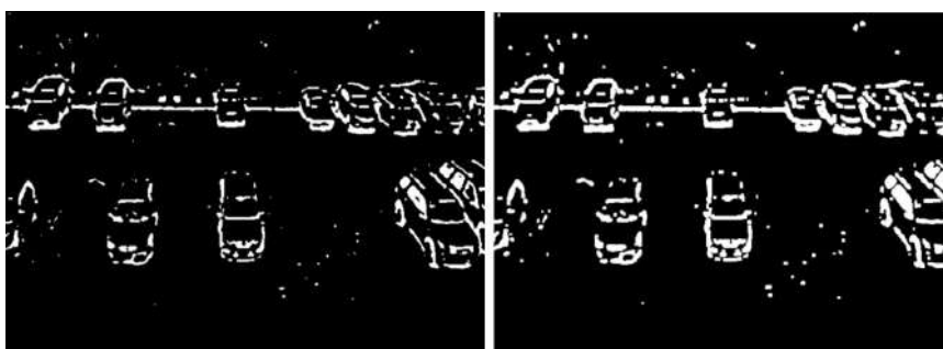
Figura 8. Operación de dilatación aplicada.
