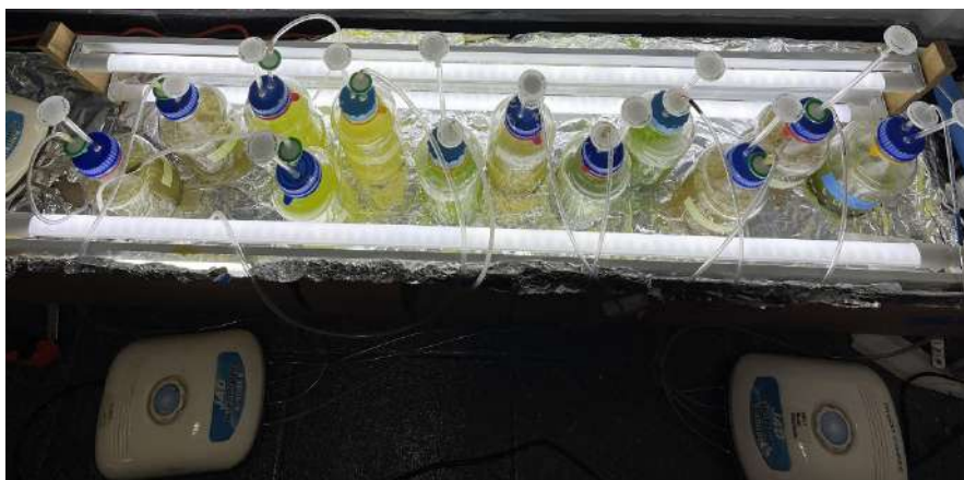
Figura 2. Mini biorreactores mantenidos a conexiones de aireación continua con filtros de entrada y salida de aire.
