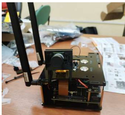
Figure 6: Jetson Nano Developer kit armado en conjunto con la cámara y módulo de audio
