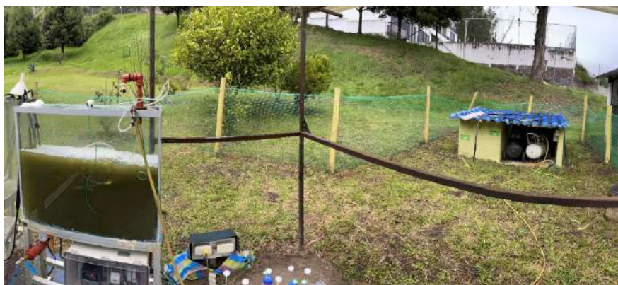
Figura 3. Fotobiorreactor cerrado expuesto a la intemperie
