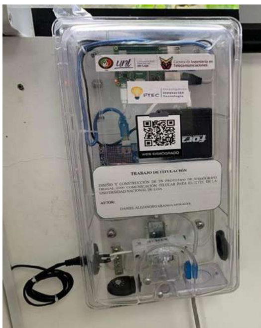
Figura 5. Prototipo de sismógrafo instalado
