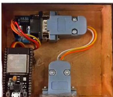
Figura 4. Conexión del hardware del sistema embebido.
