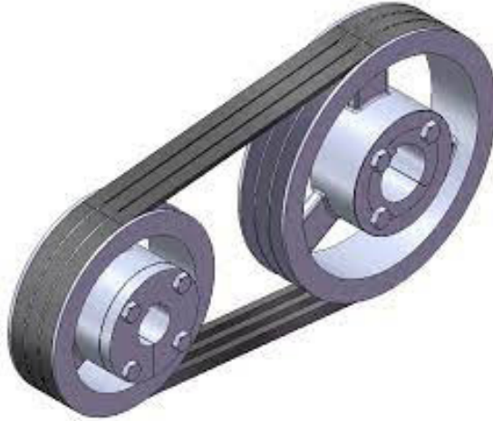
Figura 11.3. Ejemplo de una transmisión de potencia por correas trapezoidales
