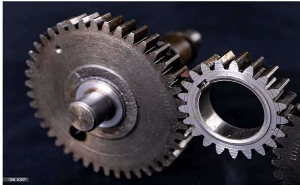
Figura 11.5. Ejemplo de una transmisión de potencia por engranajes cilíndricos rectos
