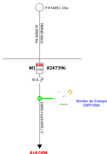
Figura 6.4. Medición general del consumo eléctrico en una vivienda.
