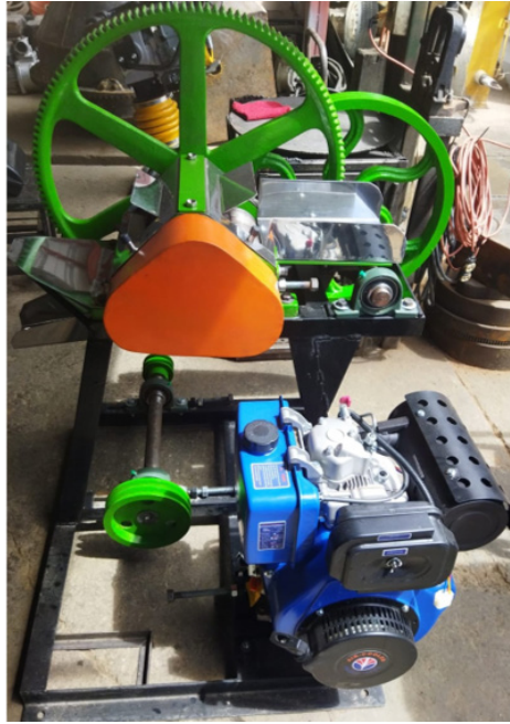
Figura 11.2. Ejemplo de instalación de transmisión de potencia entre un motor a diésel y un trapiche
