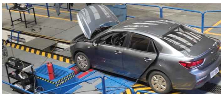
Figura 1. Montaje experimental de la unidad en el dinamómetro de chasis.
