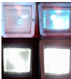
Figura 10. Diferentes niveles de iluminación Luminaria Smart Lamp (10 %, 30 %, 60 %, 100 %)
