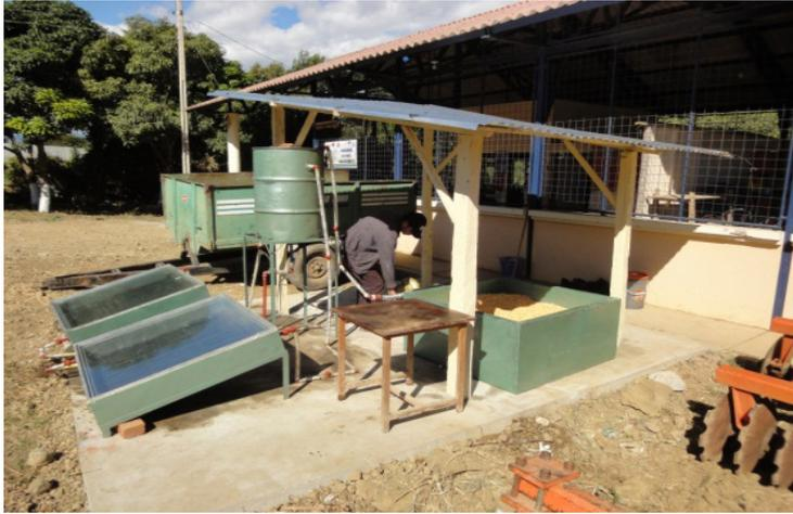
Fotografía No.4: Secador solar de maíz y maní en Zapotepamba
